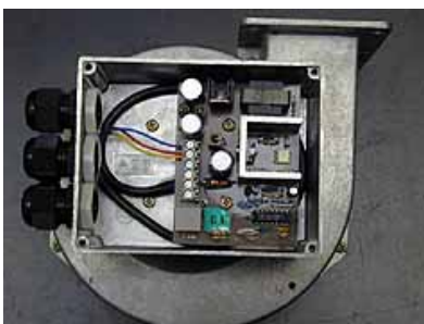
Abb. 4: TWINSOLAR Ventilator mit integriertem APW
